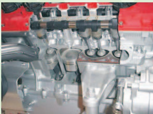
Se le valvole non sono autoregolanti (dette anche punterie idrauliche) cioè non si adattano automaticamente a questa variazione, l'auto necessita di una **manutenzione di registrazione valvole** per mantenere inalterate le caratteristiche di guidabilità ed affidabilità.
