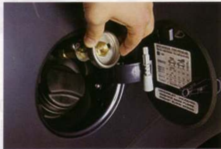
Il facile sistema di inserimento dell'adattatore GPL per il rifornimento sull'Opel Zafira alimentata a GPL o metano con il sistema Omegas Multipoint Landi Renzo.
